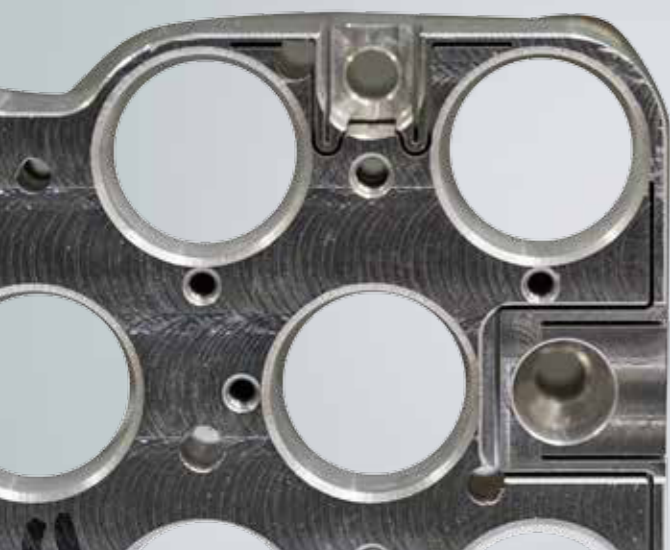
Erodierkontur zur flexiblen Ausrichtung der Plattenebene
