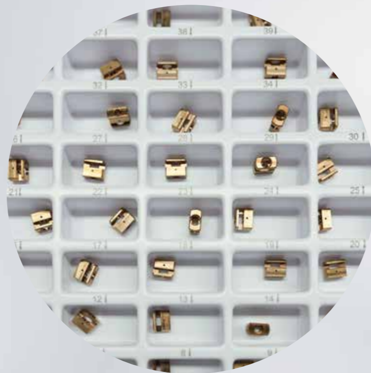
Rohteile mit beschrifteten Verpackungen zur Zuordnung der Seriennummern
